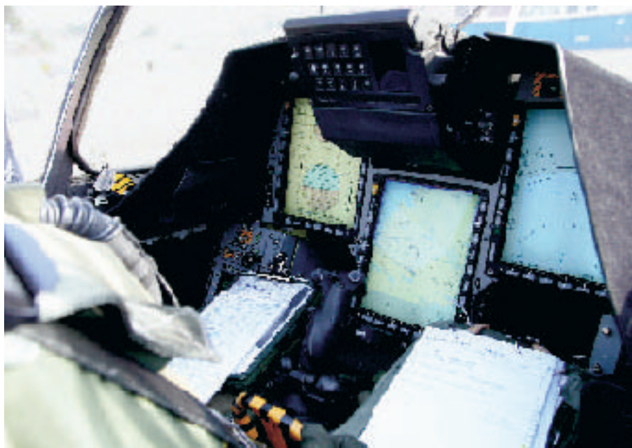
I Gripen-versionen JAS 39C får piloten systeminformationen presenterad på tre stora färgbildskärmar.
