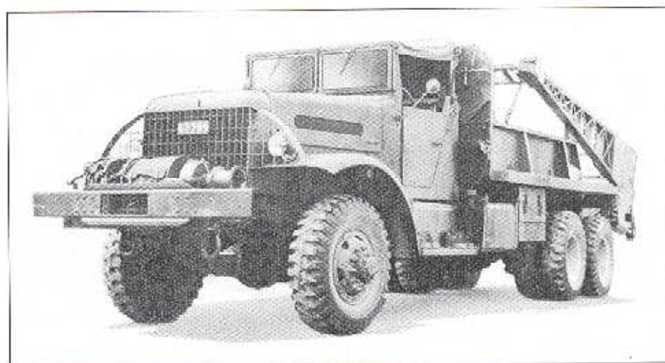
Terrängdragbil m/46 "Brockway" Bränsleförbr. normalkörning landsväg 12 lit/mil Foto: ur tygmilskatalog Mirlugp TP
