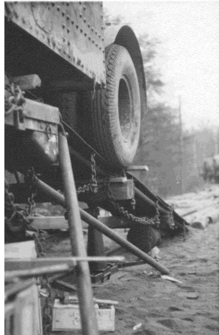
Bild 86. Lastning på järnväg utan ändlastkaj. 21 cm bäddningsfordon ca 1947
